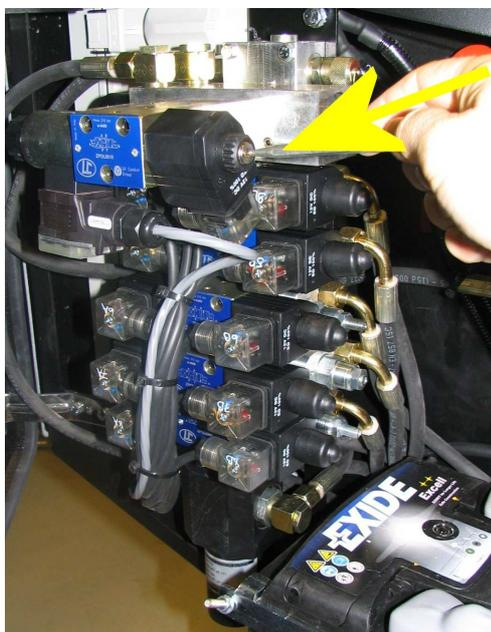
Включите систему аварийного спуска кнопкой 5 на шасси, нажмите на шпindelь клапана и направляйте движением опорных лап с помощью рычагов управления. Все действия нужно выполнять одновременно.
