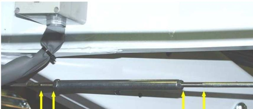
Затягивайте регулировочное колесо, расположенное за отверстием, обозначенным стрелой, до тех пор, когда колесо перестает вращаться при вращении вручную.
