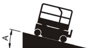
Максимальный продольный уклон в сложенном положении
