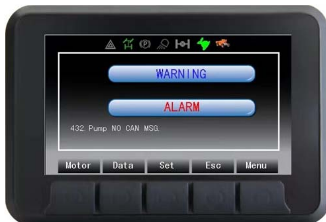
Рисунок 4.9 Интерфейс сигналов тревоги и оповещений
